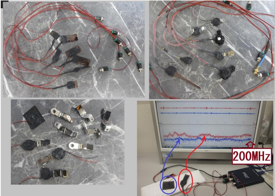
ポリイミドフィルムに鉄めっきを行った部材を利用した超音波プローブ
