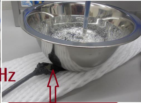
ポリイミドフィルムに 鉄めっきを行った部材
