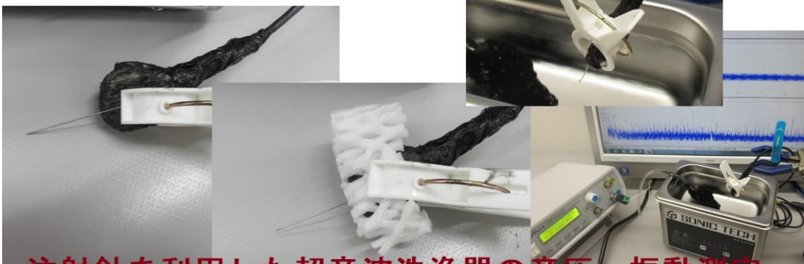
注射針を利用した超音波洗浄器の音圧・振動測定
