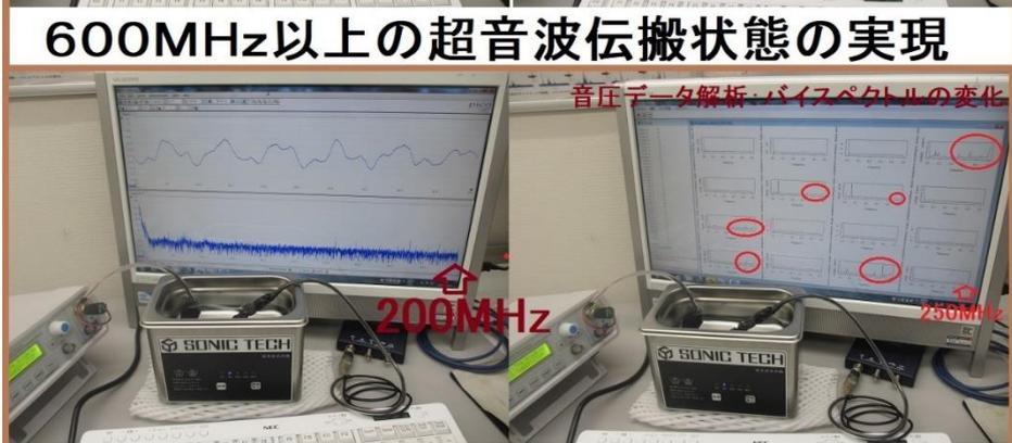
説明：超音波とファインバブルで表面処理した水槽の特性を利用した、 $600\text{MHz}$ 以上の超音波伝搬制御実験（ナノレベルの洗浄・攪拌・・・効果が高い状態）
