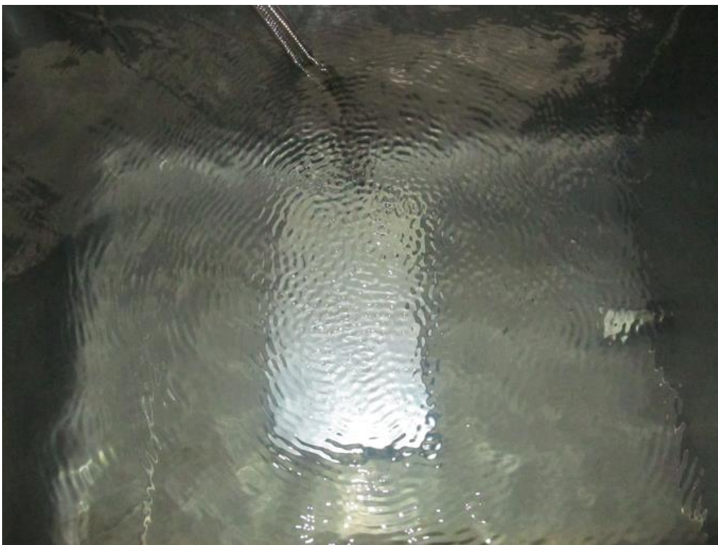
説明：定在波を強くさせた状態 28kHz 250W
