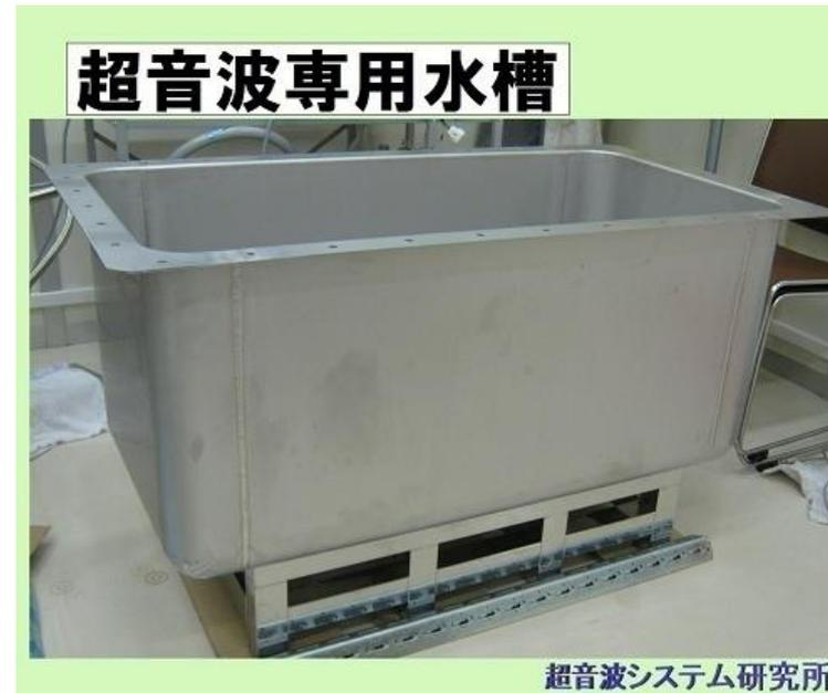
水槽の**設計**(構造・サイズ・・・製造方法)と**設置**は超音波の伝搬効率を左右します
