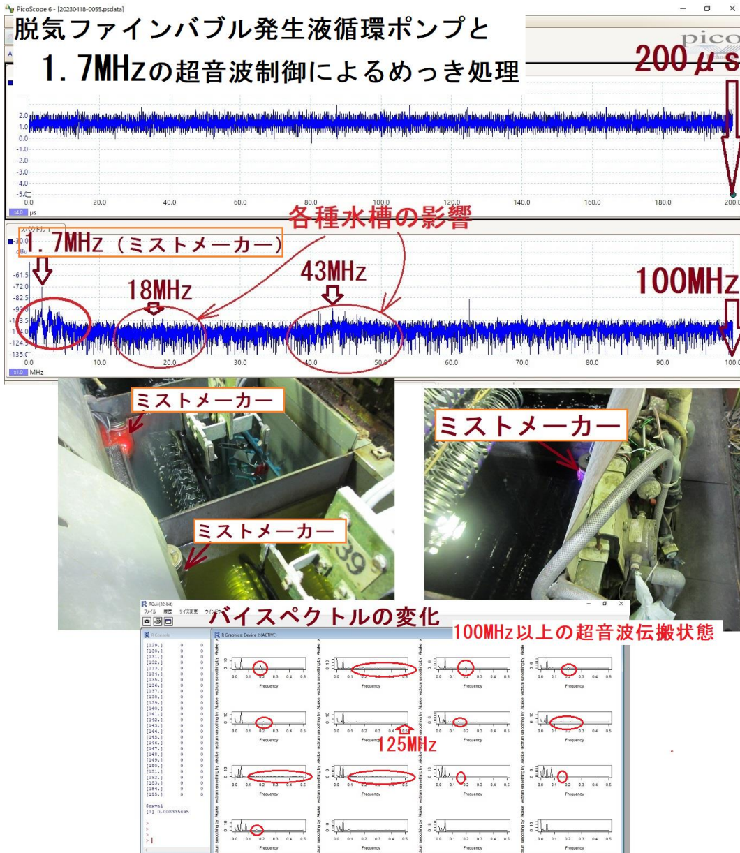
図2：超音波洗浄機と音圧データ
