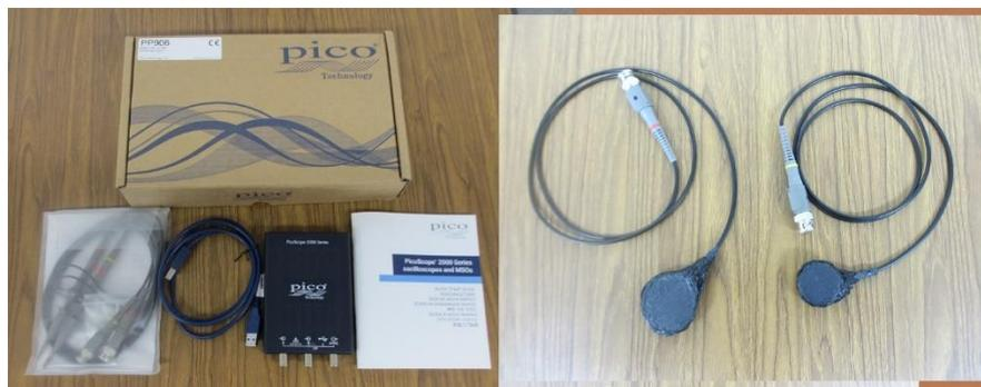
写真1 超音波の音圧測定・解析・評価システム
