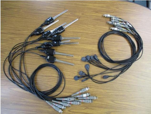
写真3 標準タイプ（洗浄液の音圧測定用と水槽表面の音圧測定用）
