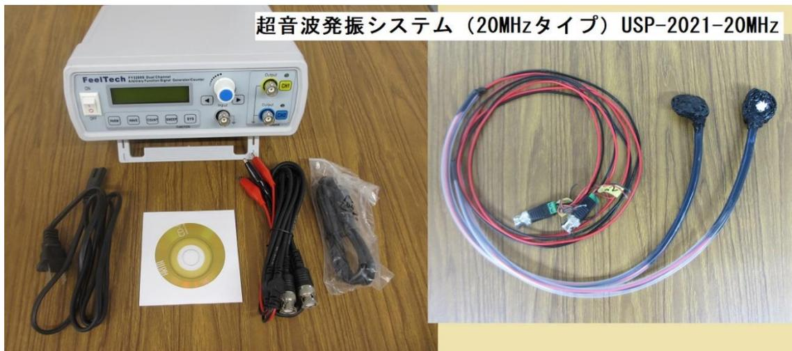
図6 超音波発振システム
