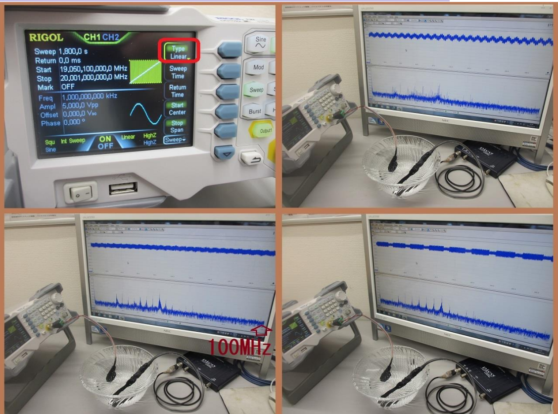
19-20MHzのスweep (Linear) 発振
