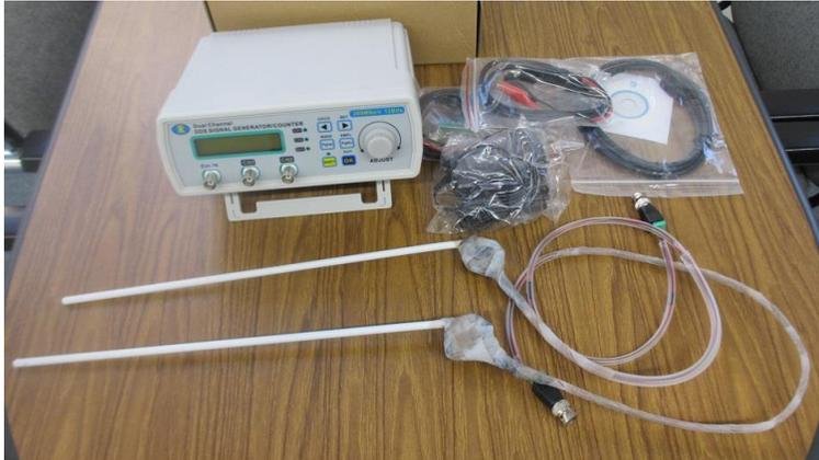
テフロン棒(鉄心入り)の音響特性を利用した超音波プローブ
