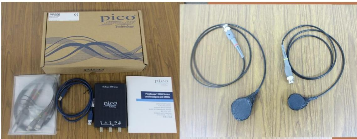
写真2：低周波（0.1 Hz～）の振動測定用超音波プローブ（特別タイプ）
