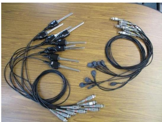
写真1 振動測定：超音波測定用プローブ
