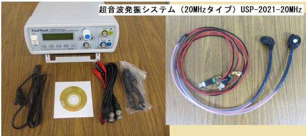
写真3 超音波の発振制御システム (超音波発振システム20MHzタイプ)
