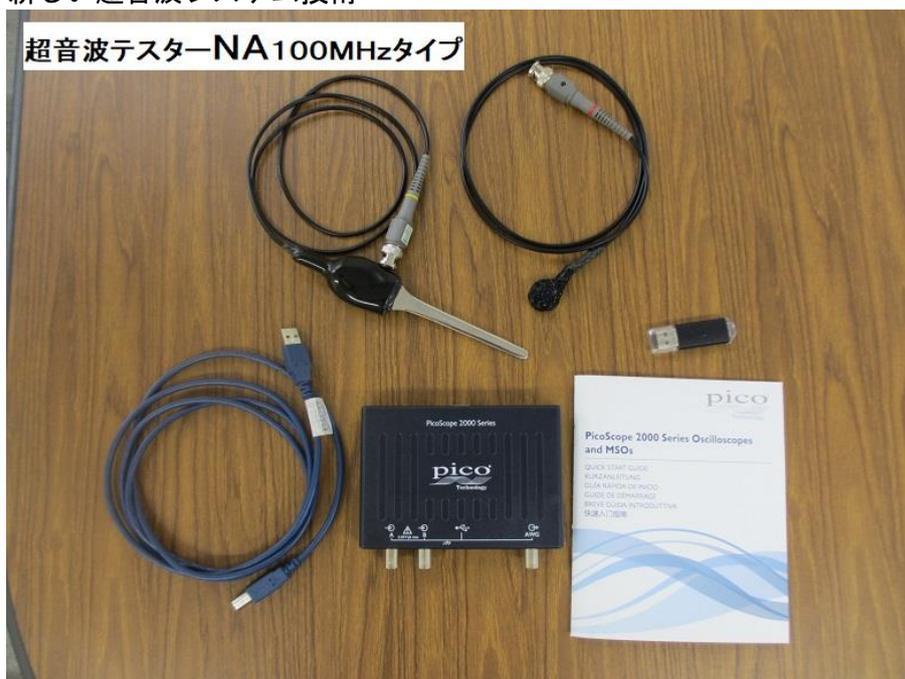
写真2 超音波の音圧測定解析システム（超音波テスターNA）
