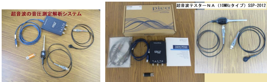
写真2 音圧測定解析システム（超音波テスターNA）
