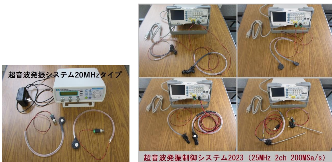
写真3 発振制御システム (超音波発振システム20MHz)
