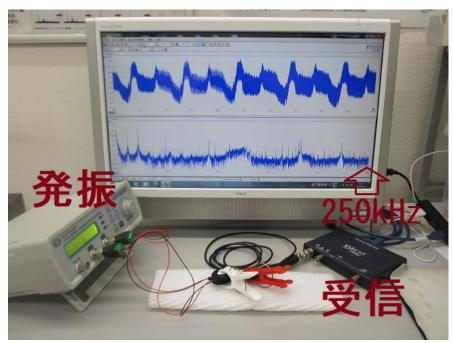
実験 1: 低周波 (9-50kHzのスイープ発振) 矩形波 (Duty 47%)、出力 13V
