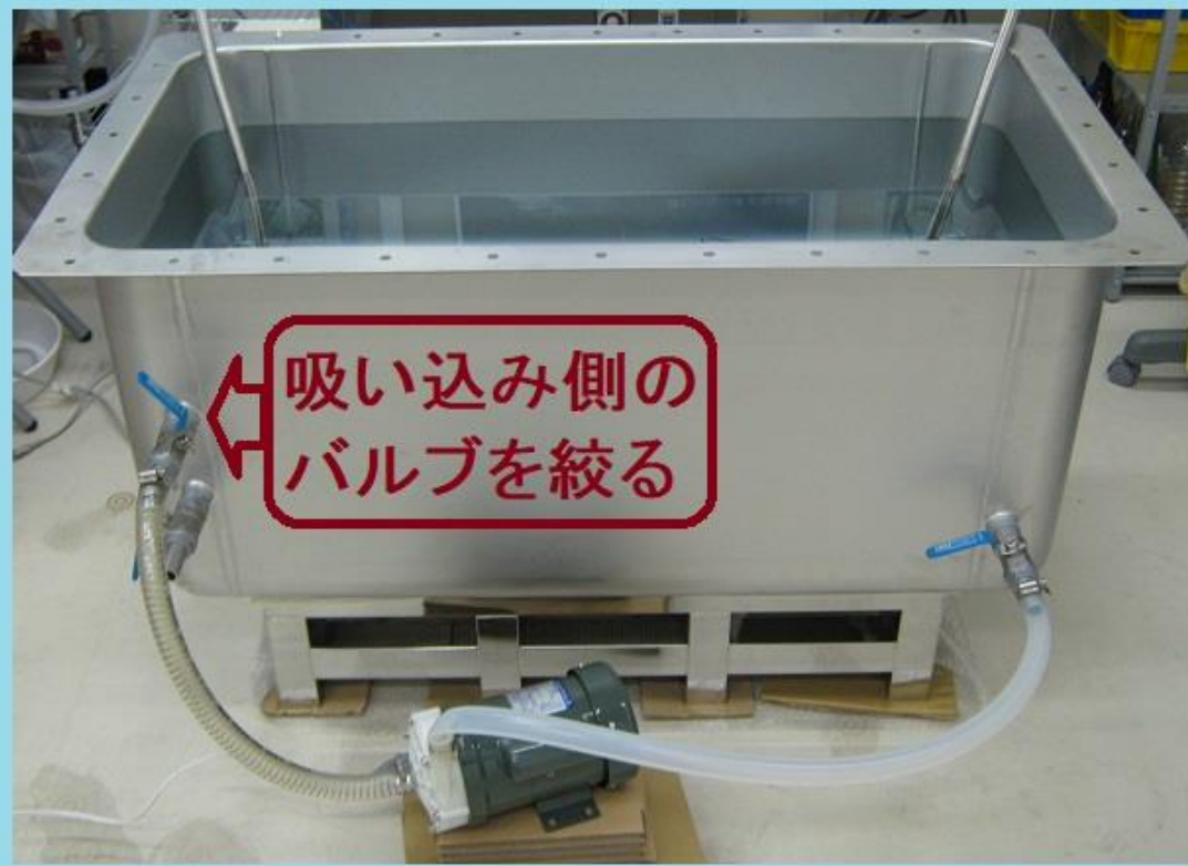
専用水槽での脱気ファインバブル発生液循環装置
