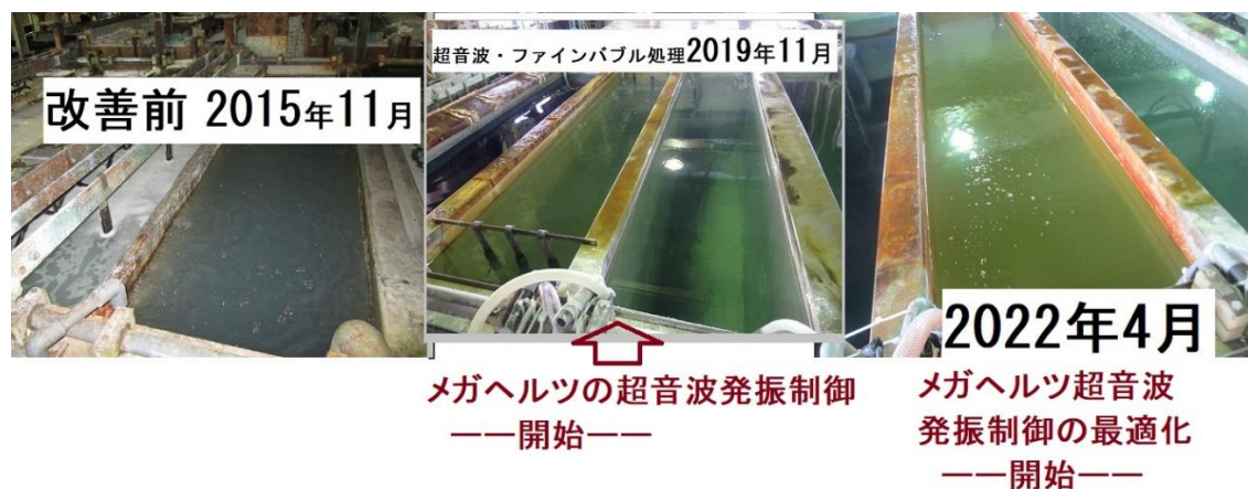
超音波とファインバブルによる水槽の表面改質効果
