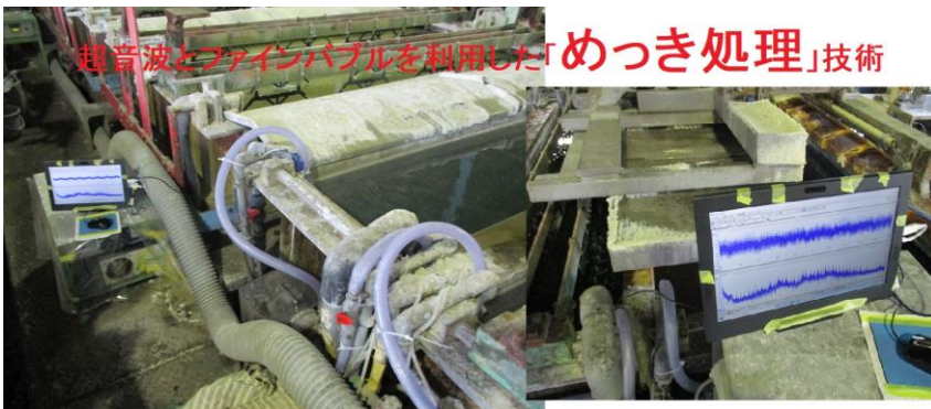
図3：音圧データと表面処理（洗浄・表面残留応力の緩和）結果
