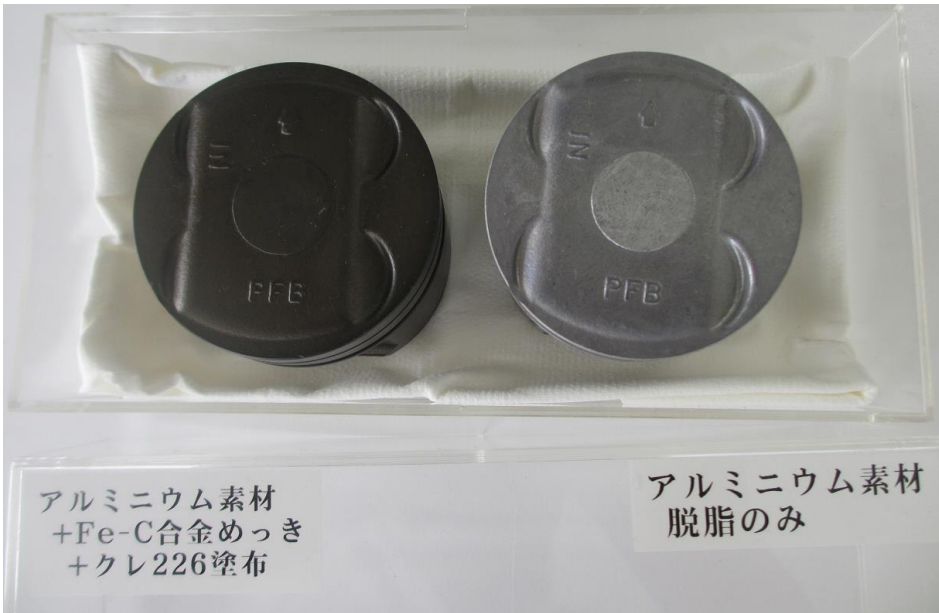
アルミニウム(A5052) +Fe-C合金めっき(研磨) +クレ556塗布
