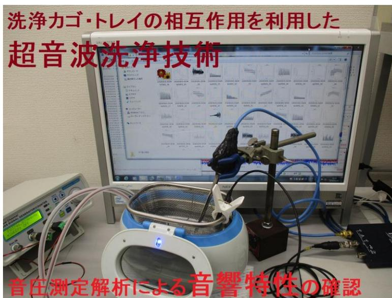
音圧測定解析による音響特性の確認
