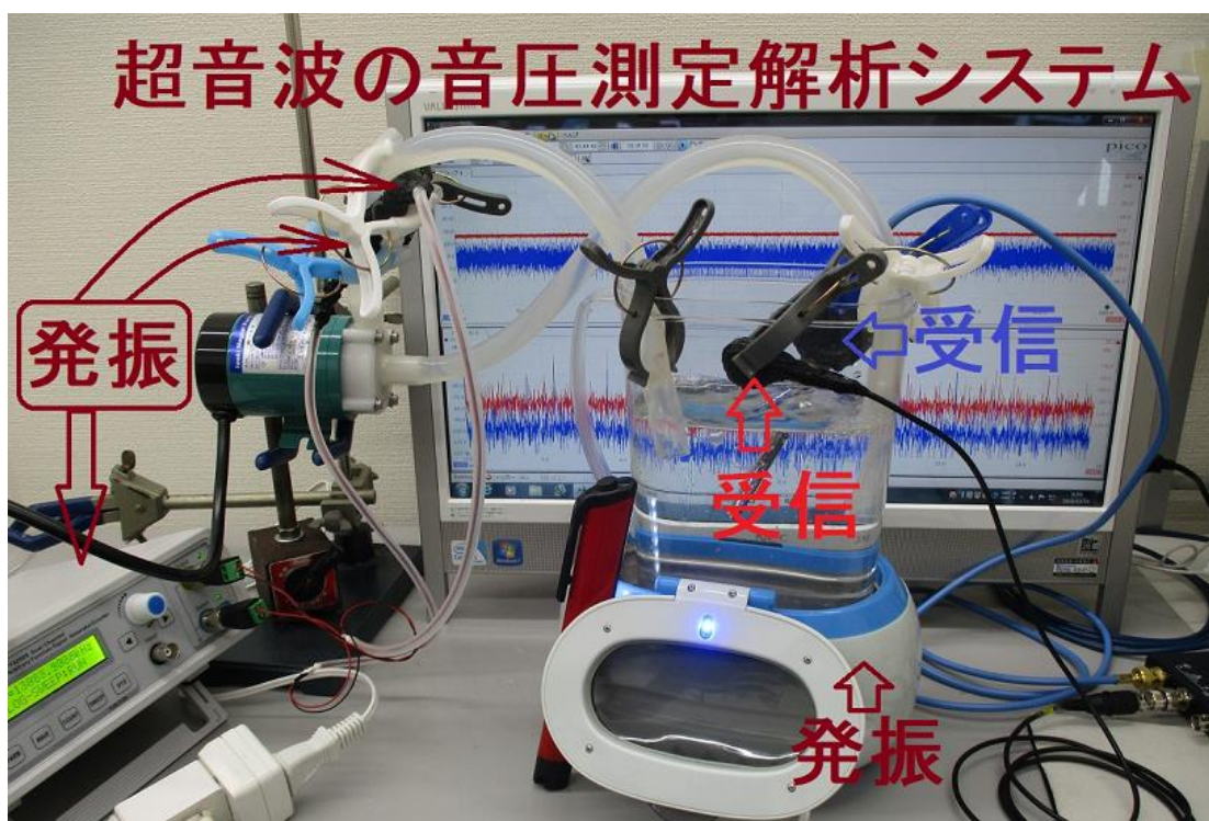
使用例 2 超音波洗浄機の音圧測定専用プローブ 樹脂容器内の液体の音圧を測定 超音波測定汎用プローブ 樹脂容器表面の音圧を測定
