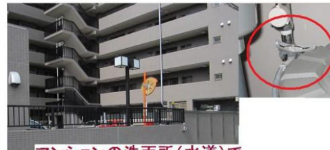
マンションの洗面所(水道)で 超音波プローブを取り付けて計測
