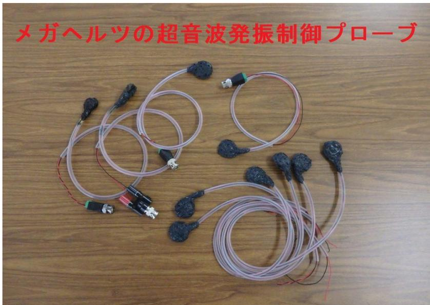
メガヘルツの超音波発振制御プローブ
