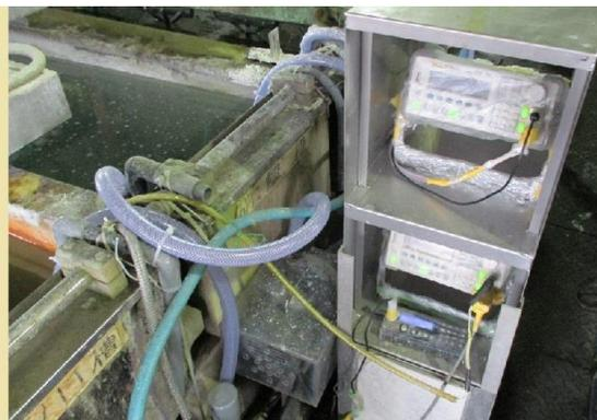
超音波システム(音圧測定解析、発振制御)
