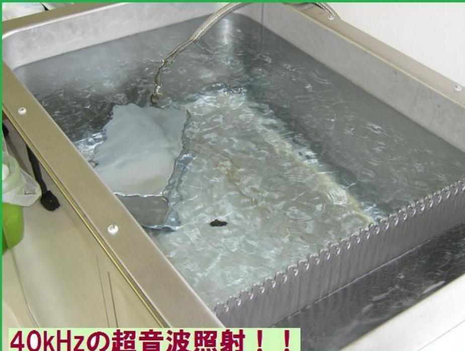
**40kHzの超音波照射！！**
