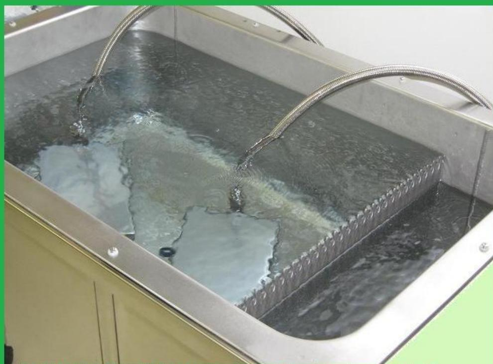
**40kHzと72kHzとオーバーフローによる
