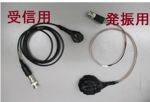
写真4 各種超音波プローブ
