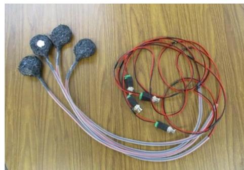
写真3 超音波発振制御プローブ
