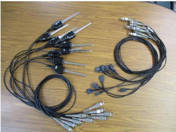
写真2 超超音波測定プローブ
