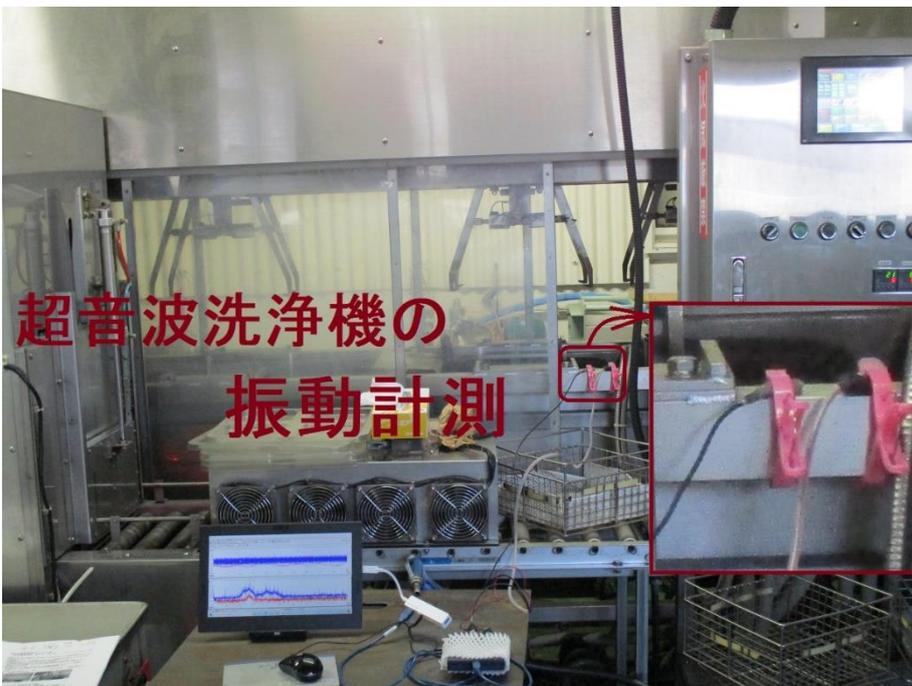
写真 18 : 超音波を利用した振動測定
