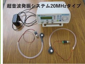
写真 17 : 超音波発振計測解析システム
