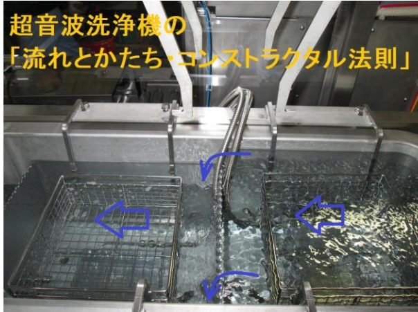
写真8：流水式超音波洗浄機
