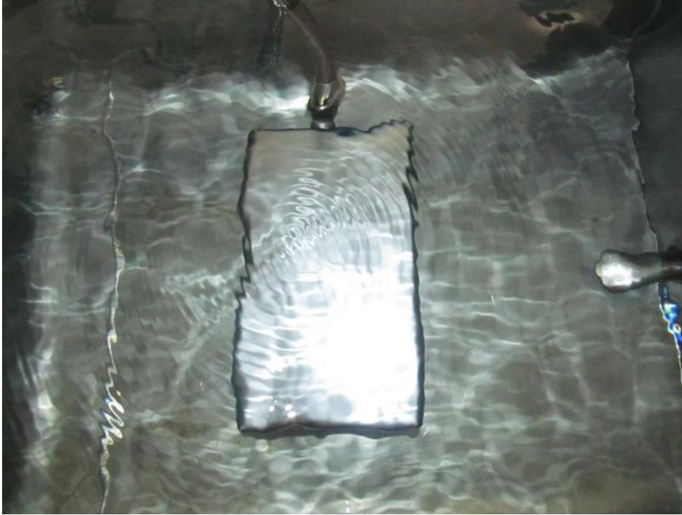
説明：キャビテーションと定在波をバランスさせた状態 28kHz 250W
