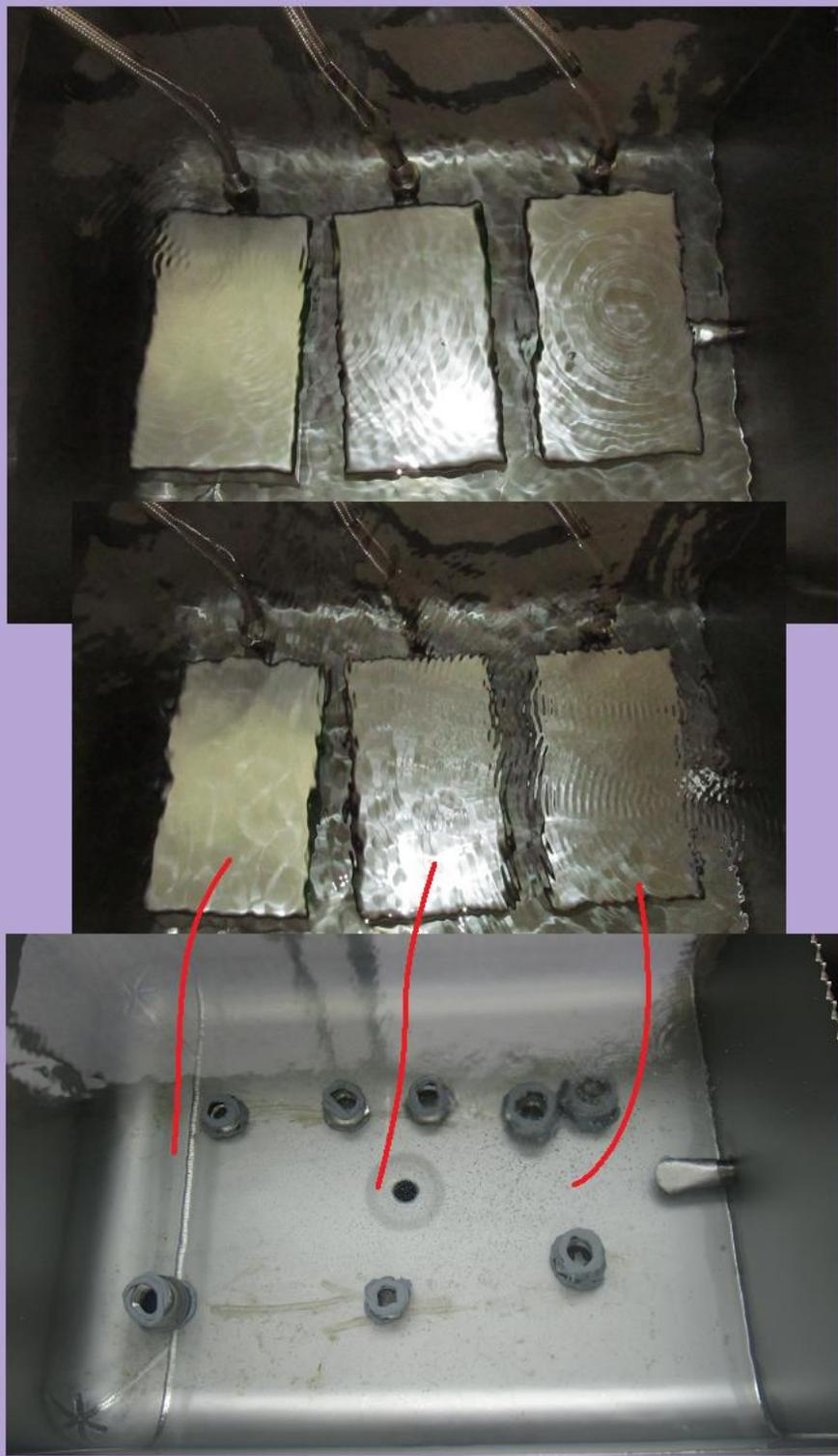
説明：振動子の超音波発振面の方向を、他の振動子と最適化することで超音波の伝搬状態の分布・ダイナミック特性が制御可能になります
