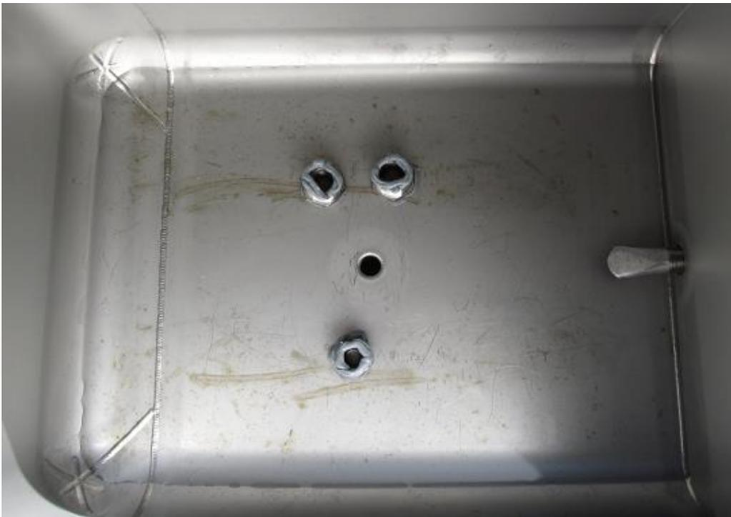
説明: 標準的な振動子設置治具の設置位置
