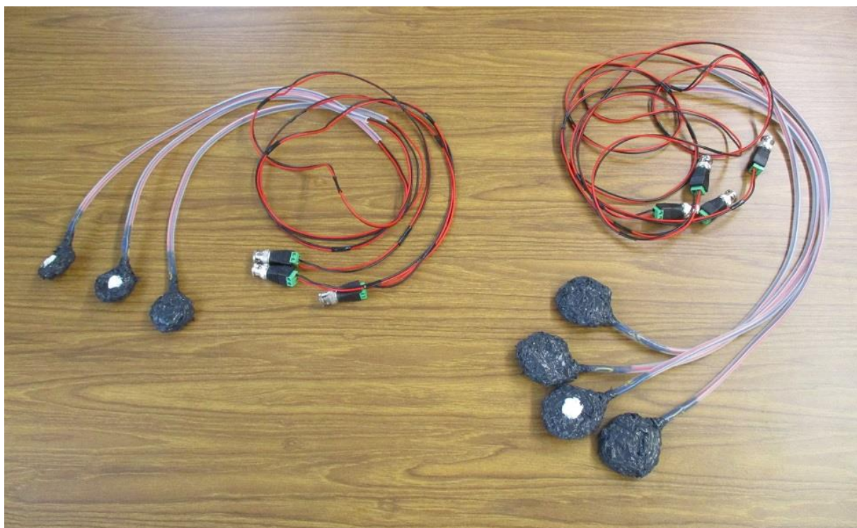
超音波発振制御プローブ（左：共振型 右：非線形共振型）
