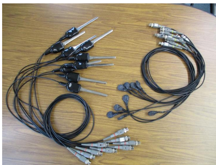
超音波発振制御プローブ（左：共振型 右：非線形共振型）
