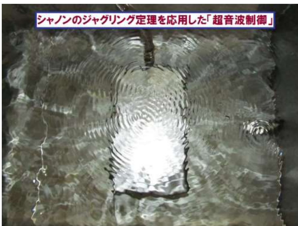
2種類の超音波振動子を利用した超音波装置！！
