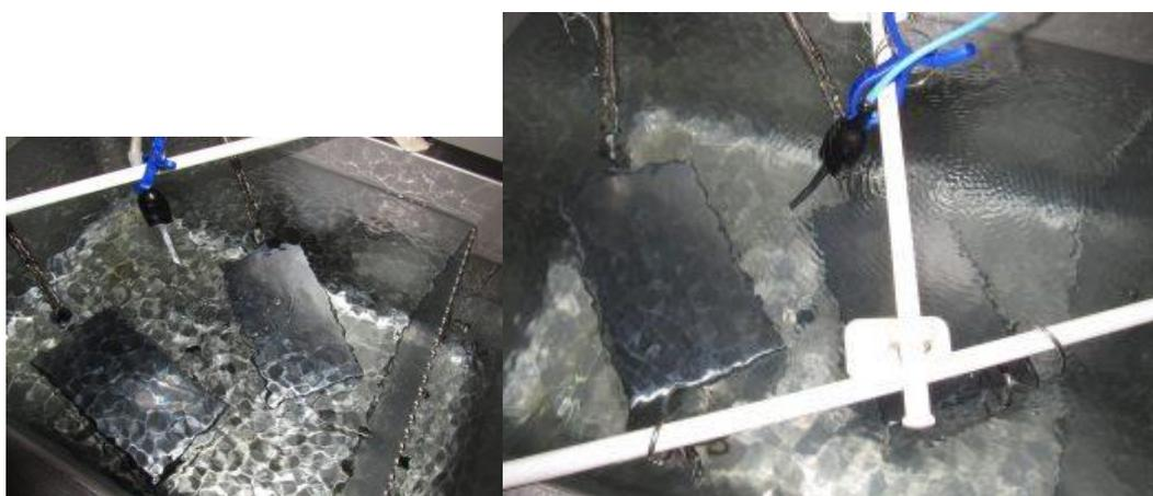
3: 洗浄物と超音波(出力・周波数)と洗浄液(液循環・・)に関する最適化が行われていないため
