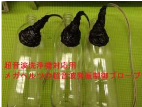
メガヘルツの超音波発振制御プローブ
