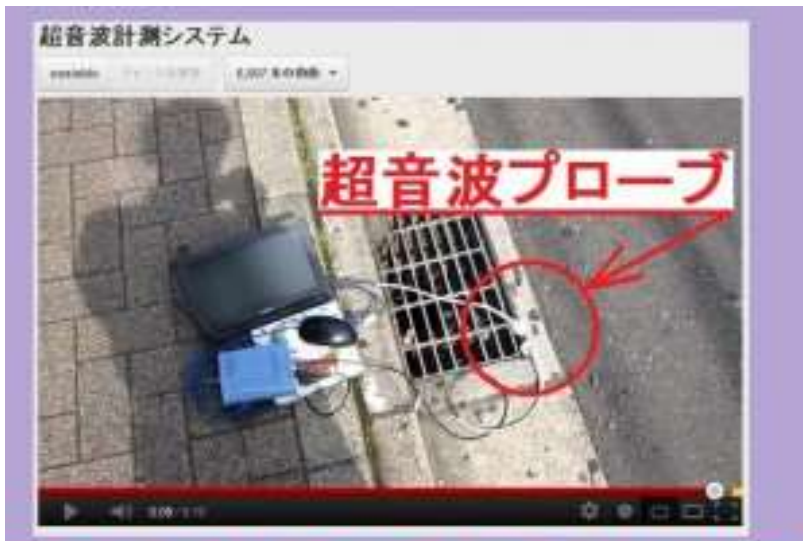
下水管を伝搬する振動計測
