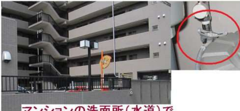
マンションの洗面所(水道)で 超音波プローブを取り付けて計測
