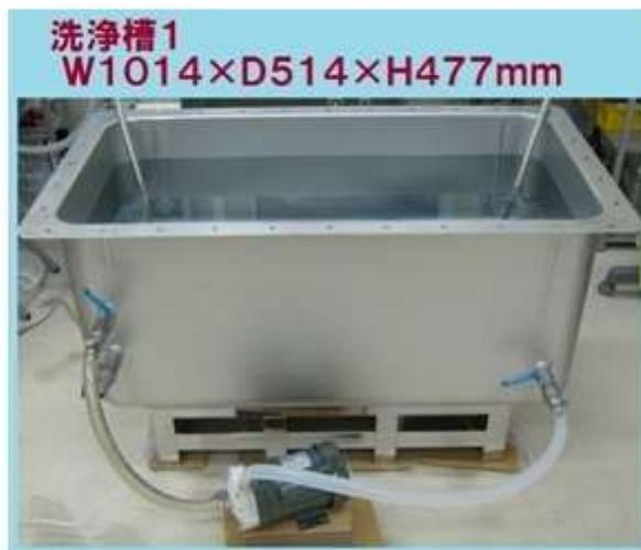
液面付近(液面から10cm下部)の液をポンプで吸い込み
