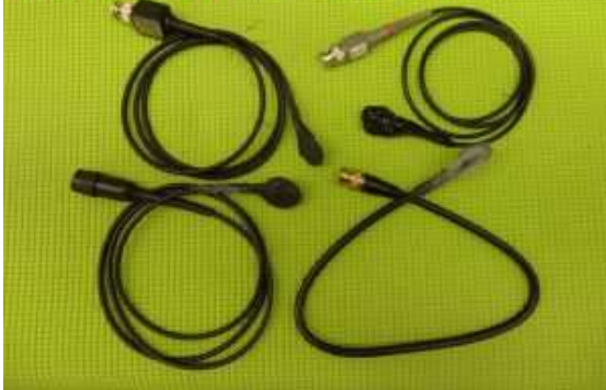
音圧測定プローブ（汎用タイプ）
