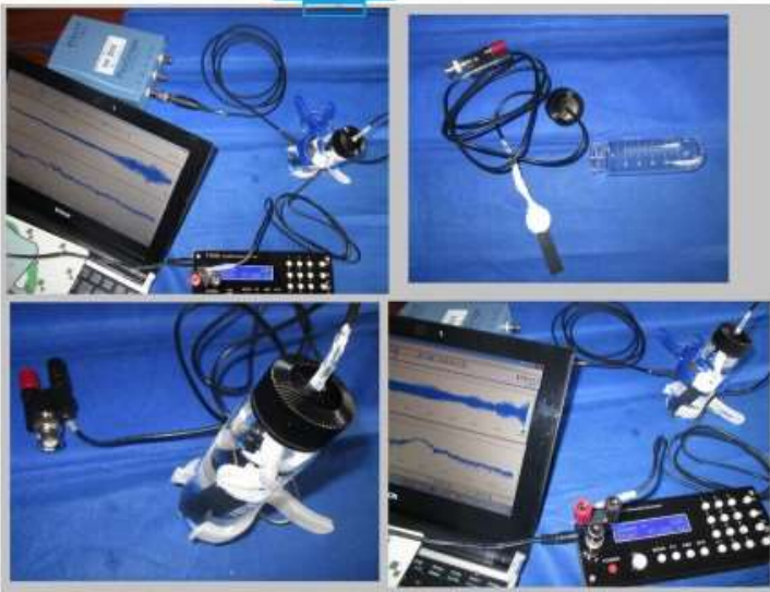
各種溶剤に対応可能な超音波システム
