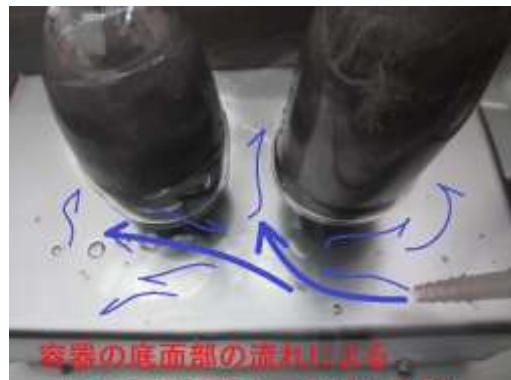
ガラス容器の揺れによる 超音波伝搬状態の変化と 相互作用を 目的に合わせてコントロールする技術
